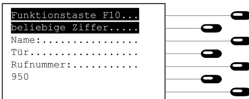
Während des Gespräches mit der Türstelle kann der Türöffner durch die Wahl der Ziffern 61 geöffnet werden. Im folgenden Beispiel wurde die Ziffernfolge auf die Funktionstaste F09 gelegt.
